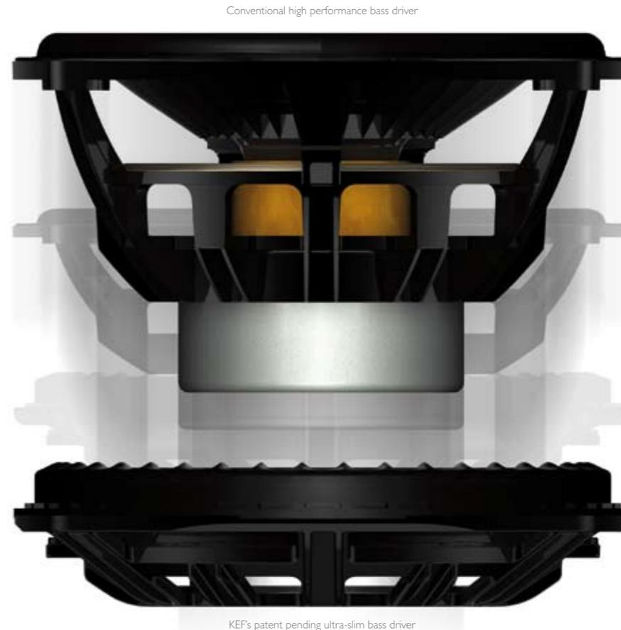
En lugar de un cono, el bajo radicalmente nuevo de doble capa y la unidad de media frecuencia cuenta con una membrana plana, cuya rigidez se mantiene en todo el rango de frecuencia gracias a unas costillas de refuerzo muy finas: el driver actúa como un conjunto de sujeción para ayudar a eliminar cualquier resonancia no deseada del fino gabinete. El resultado es tan limpio, preciso y sin distorsiones como un altavoz de alta calidad convencional, pero sin caja voluminosa.
